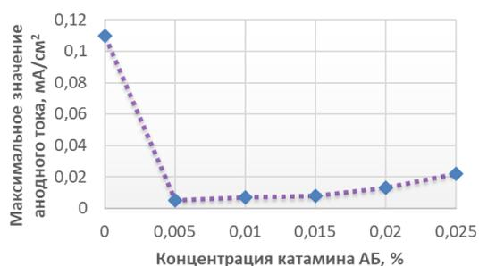
Рис. 1. Торможение анодной реакции растворения вольфрама в присутствии катамина АБ различной концентрации
