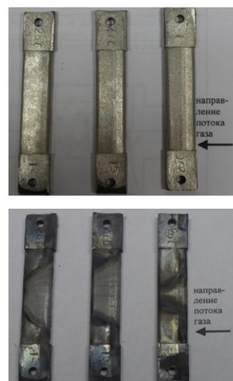
Рис. 1. Внешний вид образцов с никелевым покрытием: а - до испытания, б - после испытания.
