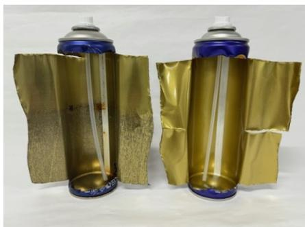
Рис. 1. Слева (коррозия) вскрытый баллон с 0,5% Контур РН, справа (без коррозии) – с 0,5% Контур РН+0,5% М-95. Время выдержки 10 мес.
