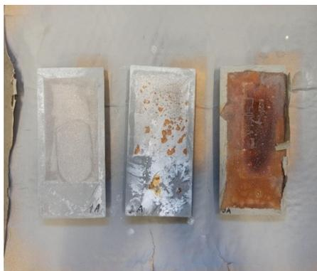
Рис. 1. Образцы связующего после проведения испытаний. 1А – щелочная среда, 2А – нейтральная соляная среда, 3А – кислотная среда
